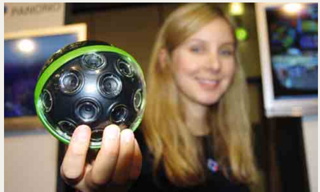
Die Kugelkamera von Panono hat es in sich – alle 36 Kameras lösen beim Wurf in der höchsten Position aus
