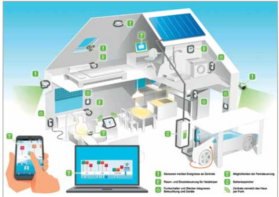
So funktioniert das Netz von RWE SmartHome
